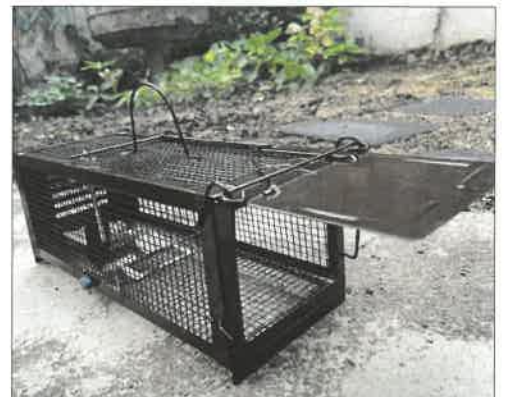
La nasse de capture C'est un piège astucieux pour attraper son rat vivant. Il faut le disposer le long d'un mur avec un appât goûteux. Un système de tringles garde la porte ouverte. Quand le rat dodu passe sur la palette de poids au milieu, la porte se referme. Une poignée de transport permet de déplacer le petit captif au loin, très loin.
